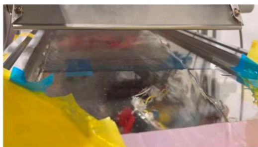
図 4：加熱による液膜破断と乾き面発生
