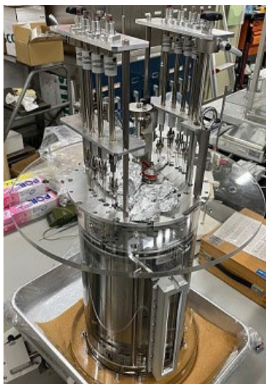
図4 温槽外から遠隔駆動のための伝達機構を組込んだ内径可変機構の動作検証。同機構を試料油に浸漬させて動作確認を行った。
