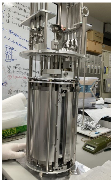
図3 改良を経て完成した内径可変機構
