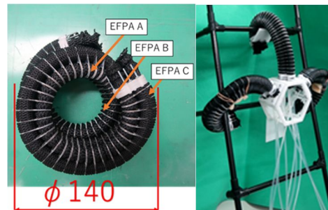
図10 らせん型EFPAと梯子昇降ロボット
