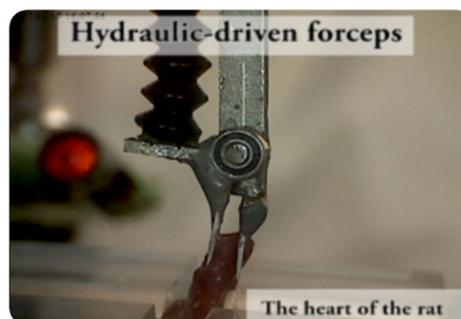
図6 生体試料を用いた把持実験結果とそのようす
