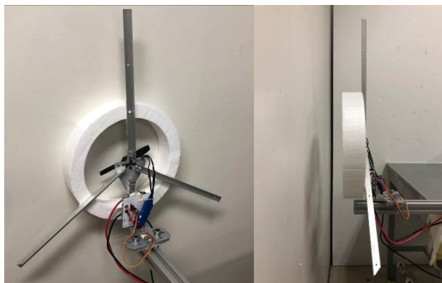
図1. 負圧式吸着機構の実験装置
