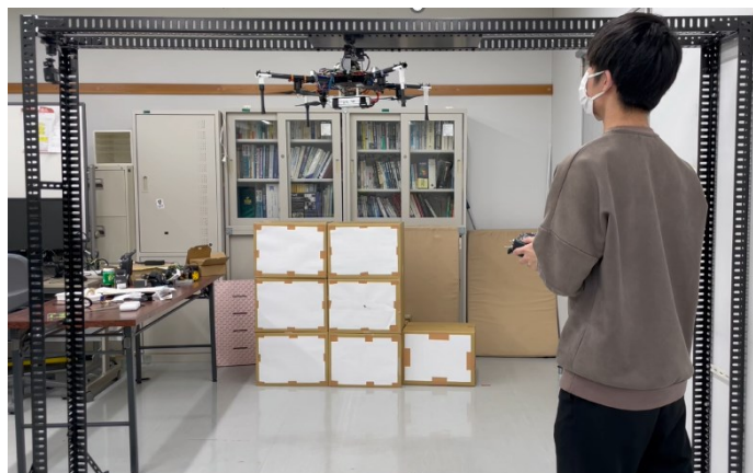
図7. 磁気吸着車輪を搭載したドローンの試作機を用いた実験の様子
