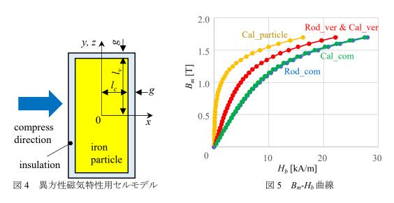
インダクタの直流重畳時の増分インダクタンス $\Delta L$  を計算する場合,圧粉磁芯の圧縮と直角方向の実効的な増分透磁率 $\Delta \mu_{ec}$  と $\Delta \mu_{ev}$  が必要になる.これらは,まず,厚み方向に圧縮成形されたリング試料 (内径: 45 mm, 外径: 55 mm, 厚み: 5 mm) に導線を 157 ターン巻き,巻線に直流電流を流した状態で LCR メータ (Keysight Technologies: precision LCR meter E4980) により $\Delta \mu_{ev}$  を実測し (Ring\_ver), $\Delta \mu_{ec}$  は上記粒子セルモデルを用いて推定した.図 6 に,実測された直流磁束密度  $B_{dc}$  を重畳した場合の直角方向の増分比透磁率 $\Delta \mu_{rev}$ ,推定された粒子の増分比透磁率 $\Delta \mu_{rp}$ ,圧縮方向の増分比透磁率 $\Delta \mu_{rec}$  を示す.
