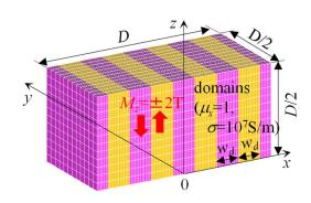
図2 異常渦電流損計算用セルモデル (1/4 領域)
