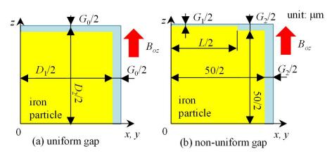
図1 古典渦電流損計算用セルモデル(1/8 領域)
