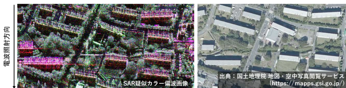
図3. 偏波の建物方位角依存性が見られる典型例。同じような建物であるにも関わらず、電波照射方向に対する立地方位角によって、偏波の応答が変化している様子が見取れる。
