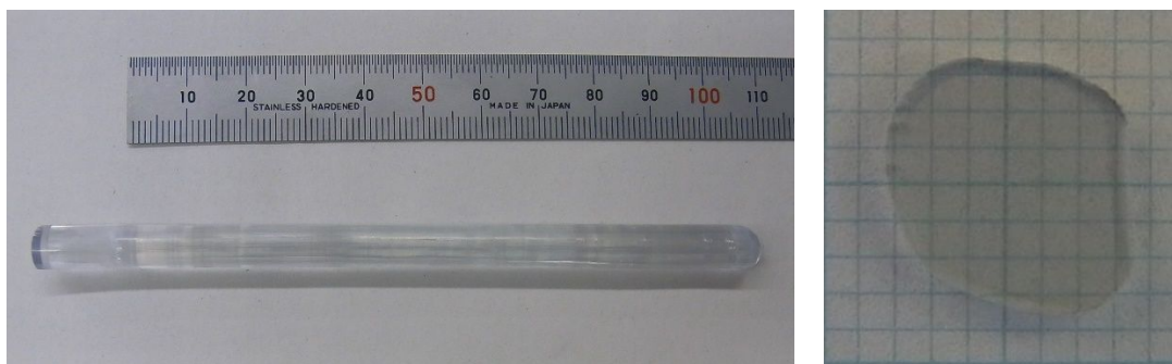
図 1 (左) -\text{Ga}_2\text{O}_3 の単結晶の外観。(右) 無双晶単結晶の断面。
