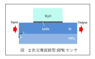
設計には、センサ入出力部での反射や、THz 波の伝搬状態を詳細に調査できる FDTD 法を用いた。計算の際に注意すべきは、InSb の厚みが  $5~\mu$  m と極めて薄く、計算精度を確保するため厚み方向の空間の刻み幅を  $0.5~\mu$  m と小さく選ばざるを得ない点である。これにより、FDTD 法の安定化条件の制限で時間刻み幅も極小に選ぶ必要があった。しかし、2 次元構造のため計算負荷はそれほど大きくなく、ある一点での周波数のデータは PC を用いて数十分の計算で終了した。ところが、実用的な 3 次元センサを検討したところ、ある周波数のデータを得るのに 10 時間近い計算が必要になった。温度変化を考慮した周波数応答を得るには 1 週間程度の計算を続ける必要がある。従って現状では、実用的な 3 次元導波路型 SPR センサの設計を効率よく行える新たな FDTD 法の開発が喫緊の課題となっている。
