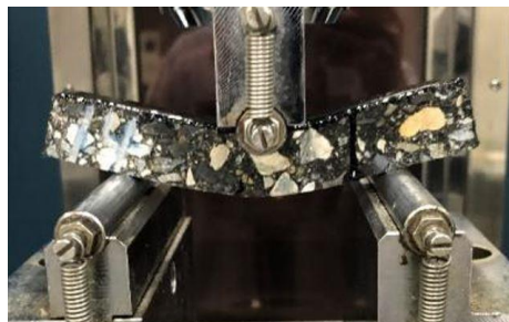
写真-3 小型供試体曲げ試験の実施状況
