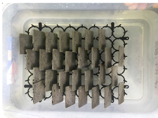
写真1 薄片供試体を用いた塩水浸漬試験の様子
