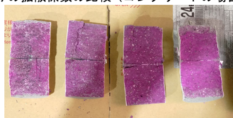
写真3 2年7カ月間促進中性化したモルタルの中性化状況
