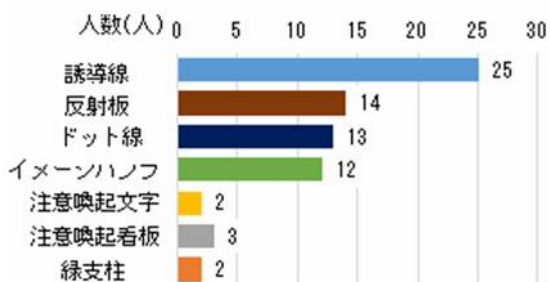
図-14 ワイヤロープからの隔離を感じた安全対策
