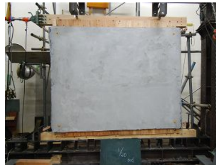
写真2 せん断加力実験の状況
