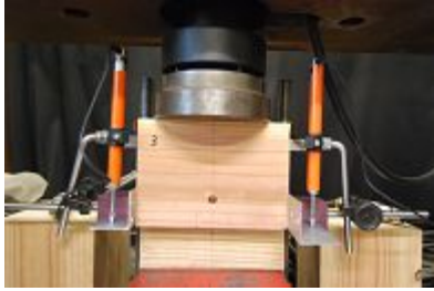
写真1 接合具の一面せん断試験
