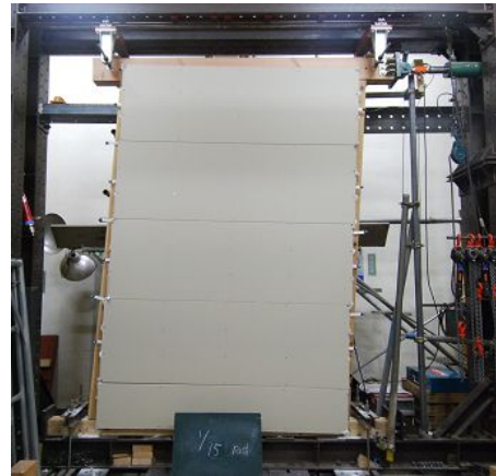
写真3 せん断加力実験の状況
