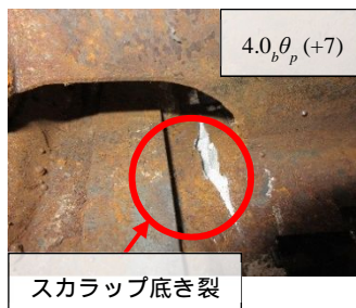
図 6 荷重変形関係と破壊状況
