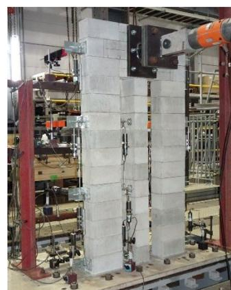
写真4 塀載荷実験の状況
