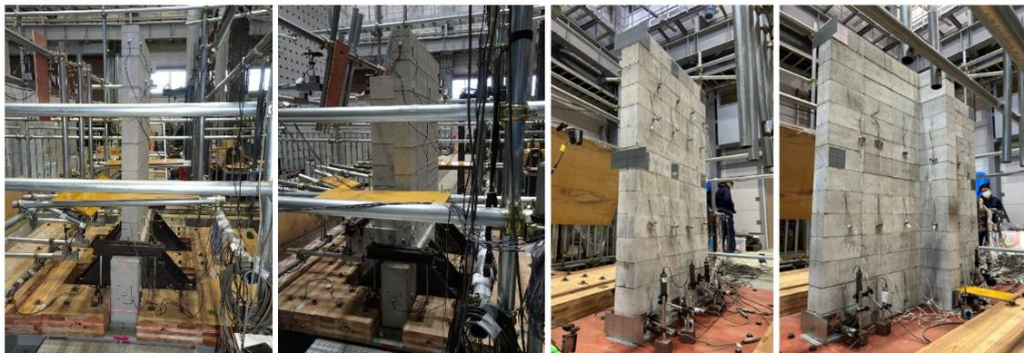
写真2 振動台加振実験の状況 (左から試験体 I800, T600, I960, T1680)
