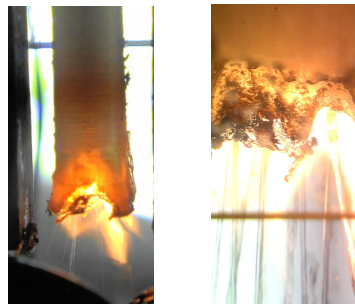
図10 キーエンス単ポート燃料(左)およびマルチポート燃料(右)の燃焼の様子
