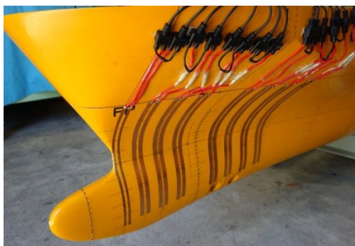
Fig.2 船体側面へのセンサ取付状況
