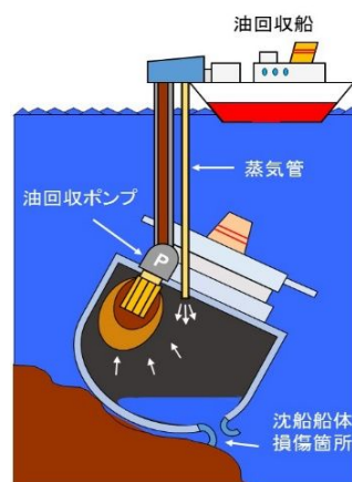
図1 従来の沈船からの重油回収イメージ
