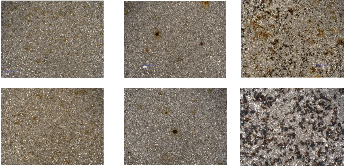
図3 シリーズにおける発錆状況（上段：70H 経過後、下段：756H 経過後） 戻り錆試験板（左） 屋外暴露試験板（中央） 人工海水付着試験板（右）
