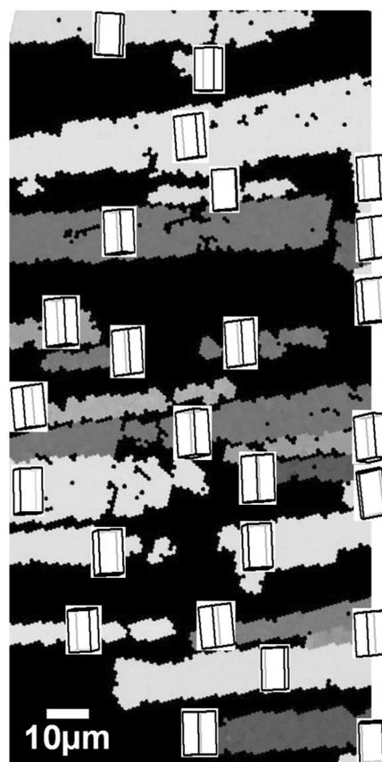
図3 「30mass% $\text{Nd}_2\text{Fe}_{14}\text{B}$ 」合金における電磁振動試料のEBSD結果 (測定された結晶格子を記載)
