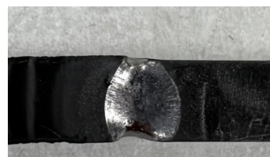
図3 溶接した試料の接合部
