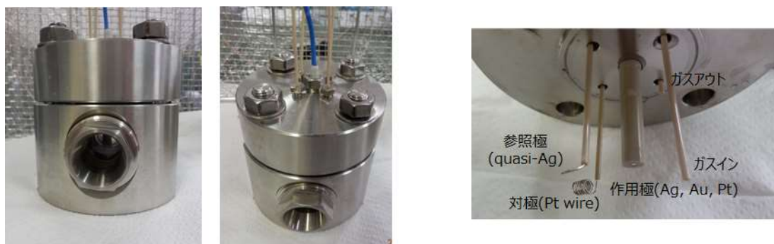
図2 サファイア窓付高圧セル(左)と三電極セル(右) : バルク電解時の作用極には平板電極を使用
