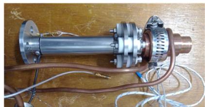
図 2 気相昇温部品と冷却部品(a)、およびその写真(b)
