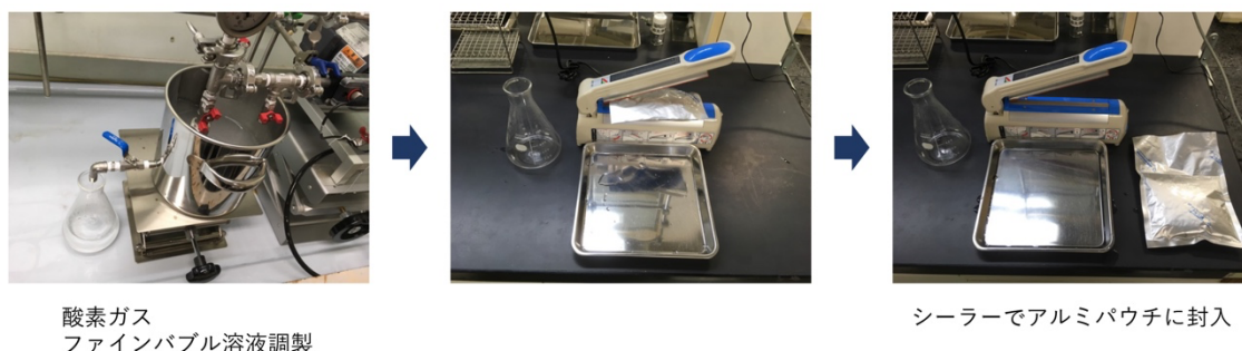
図2 高加圧のためのサンプル調製
