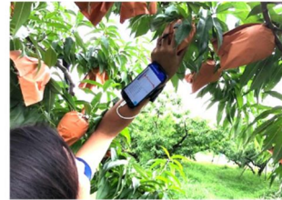
図2 果実袋上から音響振動測定を行う様子
