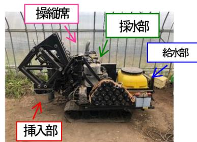
Fig. 7 自走式除塩作業機
