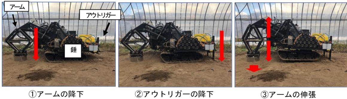
Fig.8 アウトリガーを用いた挿入部の差し込み手順
