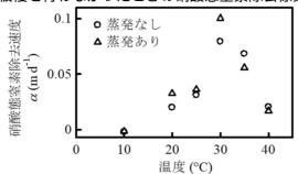
導出した式を用いることにより,蒸発のあり・なしによる硝酸態窒素除去係数の違いを適切に 評価することが可能になっている。
