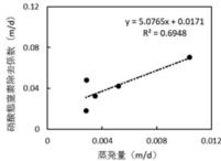
蒸発量が大きくなると,硝酸態窒素除去速度(硝酸態窒素除去係数)が大きくなる傾向があり,水面蒸発が湛水中の対流を促したため,想定的に土壌への硝酸の供給が増えたためと考えられる。
