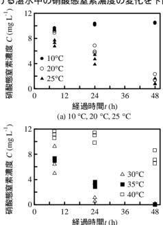
10 では初期濃度から上昇しており、土中の硝酸態窒素が溶脱していることが考えられた。 20 , 25 の試験区では一律に濃度が低下し、30 , 35 の試験区では 36 時間まで濃度が低下 し、48 時間経過時点で硝酸態窒素が検出できなくなった。一方、40 では 30 や 35 の試験 区ほど、濃度の低下が認められなかった。
