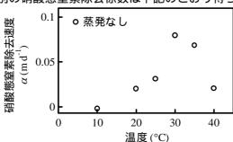
硝酸態窒素除去係数が30 をピークとして,凸となる形状を示している。多くの先行研究において脱窒菌の多くが30 から35 付近を好適な温度域としていることと整合している。
