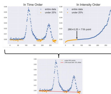
(図2) LPMによる線形ベースライン補正。
