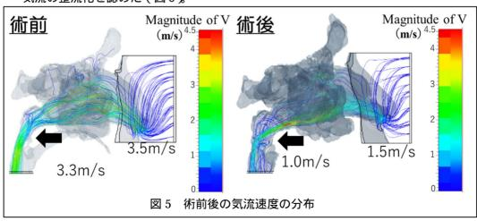
今回の結果から CFD 解析は,術前に気道狭窄部位の確認や静圧の高い部位の確認ができ,気道閉塞が生じる可能性を警鐘することや,MMA+GA の移動量や方向を検討する手段として有用性が高いことが示唆された。今後,症例数をさらに増やし,予測値との差異を反映した修正をモデル計算にフィードバックすることで,モデルの精度をさらに向上させ,手術での最適な各部位の移動量の検討に有効な予測データを提供できるものと考えられた。
