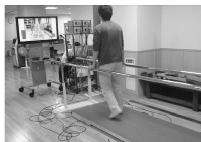
図1 床反力可視聴覚フィードバック型歩行訓練システム (科学研究費 15K01464)
