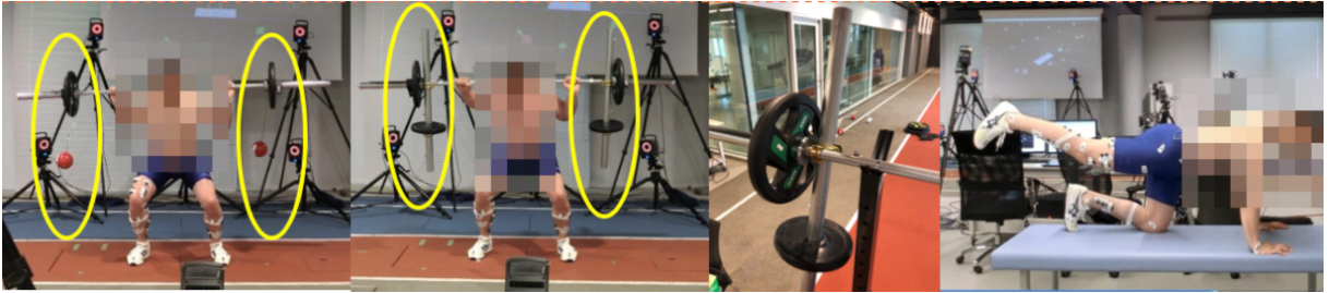
図 3(写真左:ハンマロビクス、中左:剛体、中右:剛体セットアップ、右:実験前後で下肢筋群の筋活動計測の一例。○はハンマーと剛体の位置を示す。)
