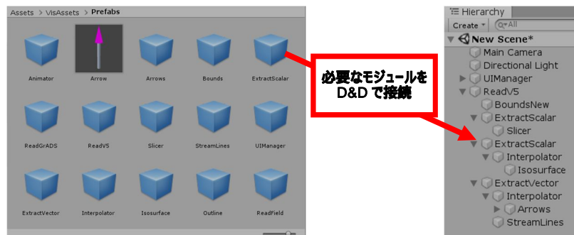
図2 VisAssetsにおける可視化モジュールと可視化ネットワーク構築
