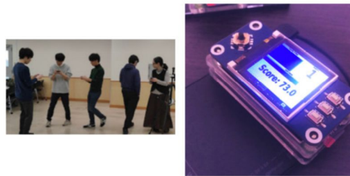
図3 社会的粒子群モデルに関する Raspberry Pi Zero WH を用いた被験者実験
