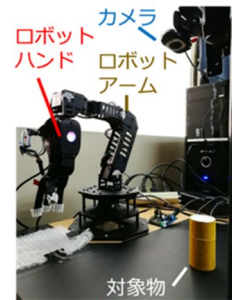
図 2 ロボットアームとハンドを用いた実験環境
