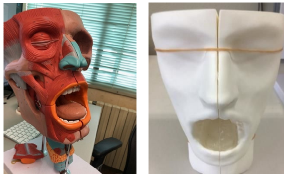
図 2. 医療用頭部模型(左)とそれに基づき作成した上気道モデル(右)
