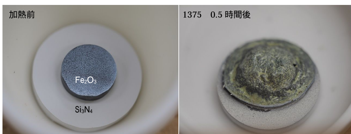
図 3 窒化ケイ素ロッド上にヘマタイトのロッドを乗せて 1375 で 0.5 時間保持した前後の写真。なお窒化ケイ素は直径 20mm、ヘマタイトは直径 10mm。
