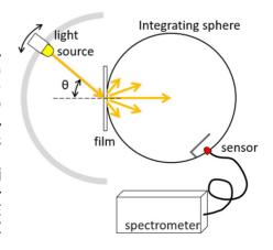
ができているとは言えない。そのため、フィルムに対して一定の大きさの光を照射し、フィルムを通過した光を積分球で集光して計測する手法を見出した。この時、太陽光の日周運動を再現できるよう、光源を一定角度範囲まで可動できるような光学系を作製して測定した。これにより、通常の直達光だけでなく散乱光成分を含むフィルムの分光データを取得することができた。
