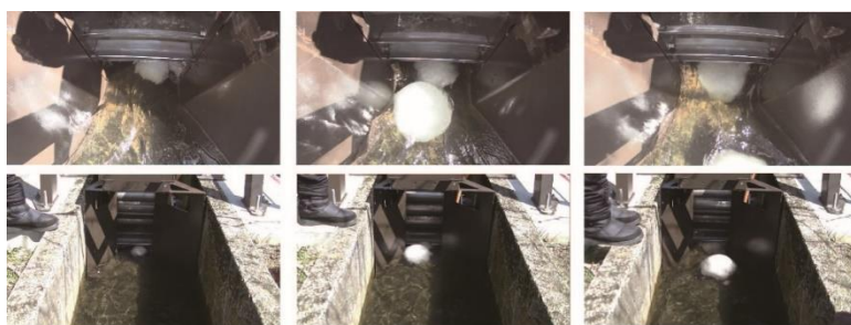
図5 水路に放出された雪玉と羽根枚数18のロータの様子 (a) d = 130 mm, t/T_0 = 4.2 (Case A) (b) d = 210 mm, t/T_0 = 4.2 (Case B) (c) d = 240 mm, t/T_0 = 4.2 (Case C)
