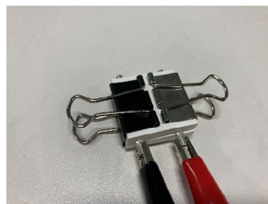
図2 BN 板上に形成した CNT ネットワークの抵抗率測定治具
