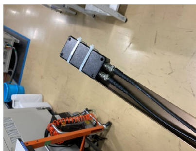
図4 ビーム口より挿入する試料ホルダー
