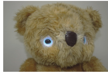
図8 ハイライト表現を付加した瞳孔反応ペットロボットの様子
