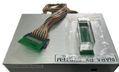
図5 新型感圧センサ(上に乗っている透明の棒状のものがセンサ本体)
