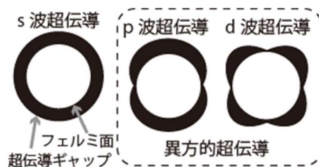
図1 s波、p波、d波クーパー対を持つ超伝導体。
