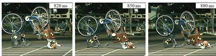
図2 幼児ダミーの路面衝突時の状況（ヘッドレストなし，シートベルト着用）
