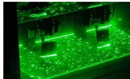
図3：首長竜ロボットの遊泳実験とヒレ周りの渦列の干渉計測
