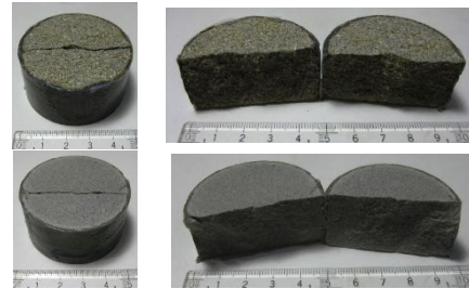
図2 破壊した岩石試料：(上)来待砂岩、(下)白浜砂岩。
