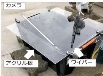
図-1 雨滴画像から雨量を計測する手法
