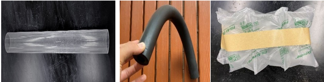
図3 対策工（左：アクリル筒、中：ゴム筒、右：空気袋）
