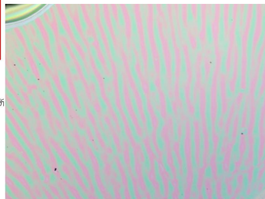
図4: 感温塗料 (Ru(Phen)) 薄膜の顕微鏡写真
