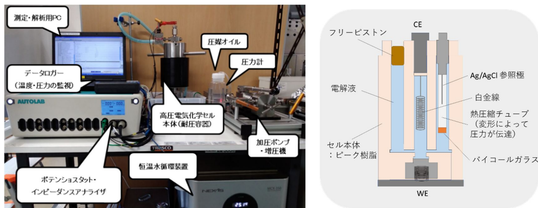
図2 (左) 本研究で開発した超高压電気化学測定装置の全体像。(右) 耐圧容器に設置した3電極式気密セルの構造模式図。
