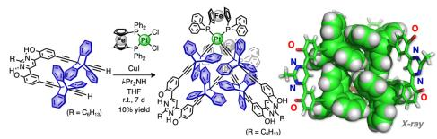
組み込まれた分子ギア (C) の合成にも成功した.この化合物では傘歯車と平歯車が連動して回転運動を起こすという前例の無い回転機構を有する分子機械である.
