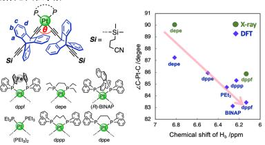
素間の角度(∠C-Pt-C))が変化するため、これに付随して2つのトリプチセン間距離が変化することで、反対側のトリプチセンのフェニル環からの遮蔽効果が変化したためであると考えられる。実際、∠C-Pt-Cとトリプチセンのケミカルは線形的な相関を示した。すなわち、ケミカルシフト値を用いてトリプチセン同士のかみ合いの強さを推し量ることが可能であり、ジフェニルホスフィノフェロセン(dppf)を配位子にもつ場合に最もかみ合いが強くなることが判明した。
